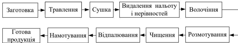
Рис. 2. Послідовність технологічних операцій волочіння дроту зі сталі
