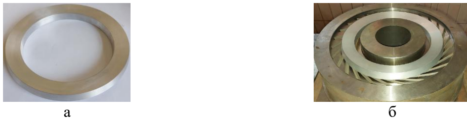
Рис. 14. Заготовка (а) для ізотермічного штампування моноколеса та її розміщення в ручаї штампу
