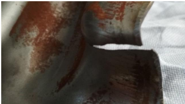
Рис. 7. Характер руйнування скорегованої заготовки при деформуванні
