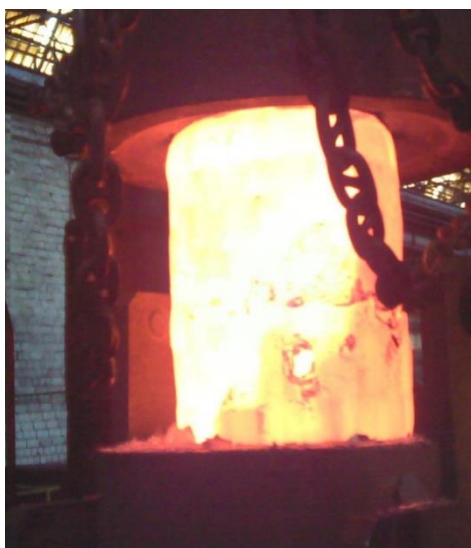
Рис. 8. Осаджена заготовка з діаметром і висотою конічних виступів d/D = 0,9 h/D = 0,2 відповідно
