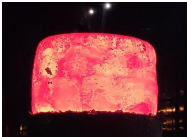
Рис. 7. Осадка заготовок з уступами плоскими плитами
